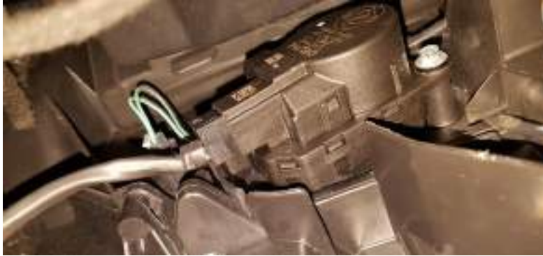
Takaläppien aktuaattori paikallaan. Vasemmalla auton keula
